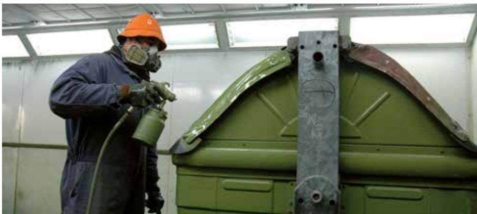
> Taller de reparación y pintura de contenedores dañados. Foto: Jorge Sánchez.
